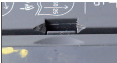
Photo 5 Si le compartiment des piles est endommagé, le couvercle ne peut plus être verrouillé correctement.
