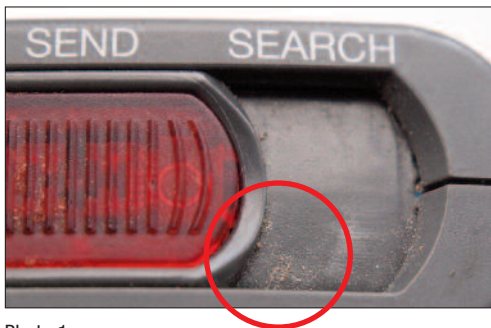
Photo 1 Interrupteur principal contaminé
