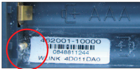
Photo 15: Connecteur principal contaminé
