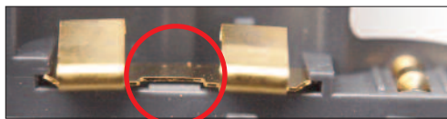
Photo 13: Contacts des piles pas verrouillés correctement
