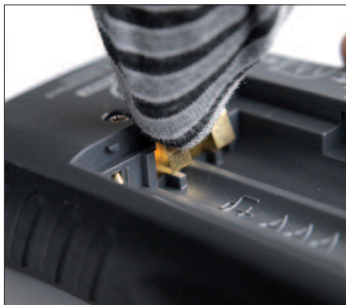
Photo 12: Nettoyage d'un contact de pile.
