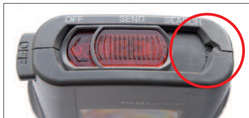
Photo 3 Boîtier endommagé dans le coin supérieur droit. Un tel appareil doit être vérifié par un point service Barryvox officiel et ne plus être utilisé!
