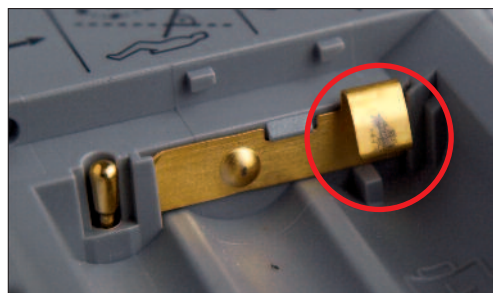
Photo 9: Un contact inférieur de pile contaminé
