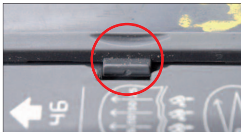
Photo 6 Le dommage est causé par des utilisateurs qui ont essayé d'ouvrir le compartiment des piles avec un outil inapproprié et en appuyant directement sur le crochet de verrouillage. Ce dégât n'est pas couvert par la garantie.
